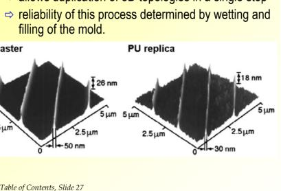
>50 nm PDMS Mold prepolymer PDMS Cure, peel off
