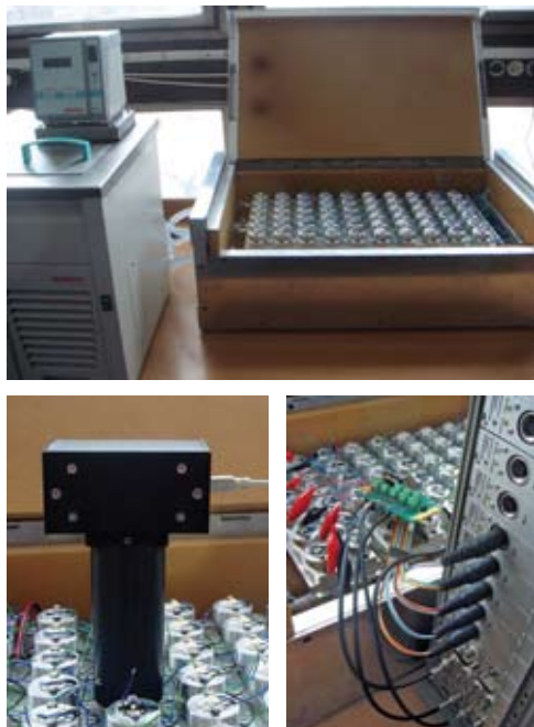
5. a, b, c ábra Az LM80-as szabványnak megfelelő öregítő berendezés: a) 60 LED az öregítő kamra belsejében és a kamra stabil hőmérsékletét biztosító folyadékos termosztát, b) integráló csővel történő relatív fényáram és színindex-összetevő mérése helyben, c) termikus impedancia mérése a T3Ster® nevű berendezéssel [14], szintén helyben
