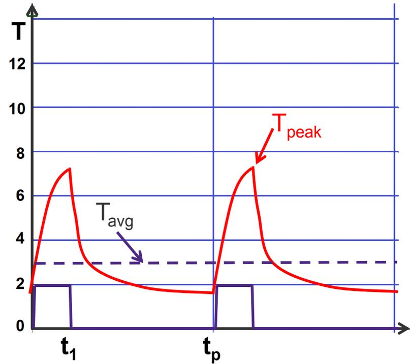
$t_1=1\text{ms}$ ,  $t_p=5\text{ms}$ ,  $\delta=0.2$ ,  $f=1/t_p=200\text{Hz}$ ,
