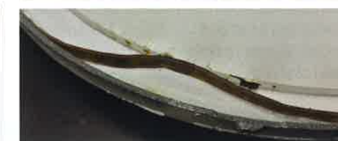
2. ábra. A világítótest oldaláról levált LED-szalag és az elszenesedett belső diffúzor lemez
