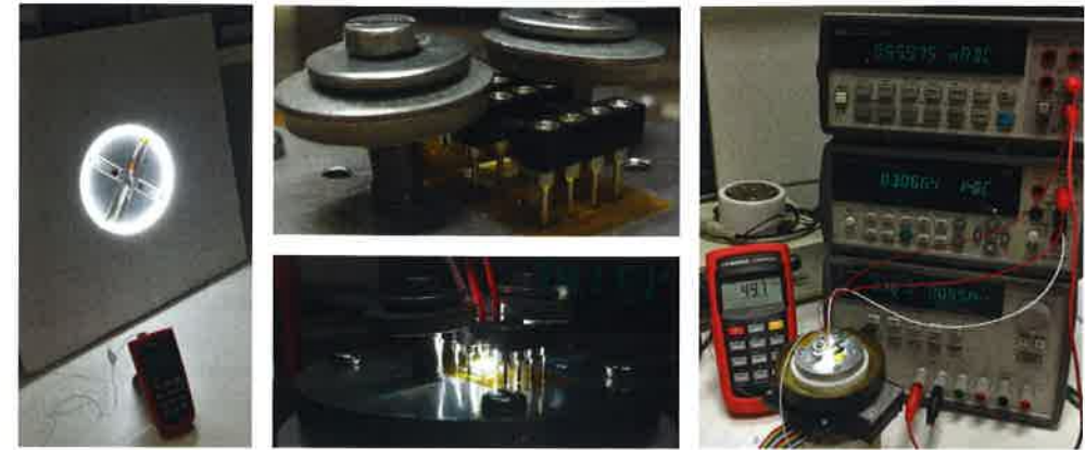
11. ábra. A gipszkarton álmennyezetre szerelt és behacsolt világítótest hőmérsékletének és a párhuzamos szegmensek feszültségének mérése (balra); a hiszerelt LED minták 4 vezetékes rögzítése (középen) és termosztált mérése (jobbra)
